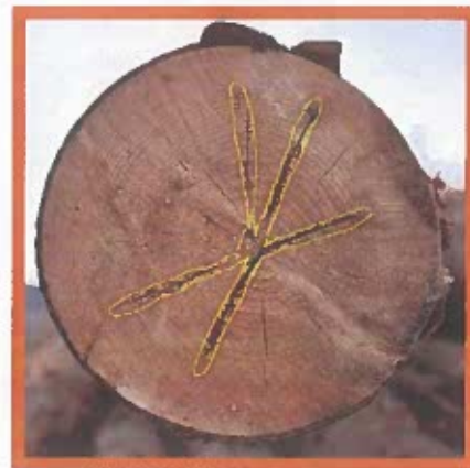
Crăpătură frontală superficială de inimă
